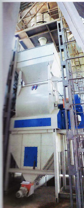
Узел смешивания на базе ЗСЛ-4000 с модулем микродозирования компонентов МДК-50-8 (комбикормовый завод компании «Агропродсервис»)
