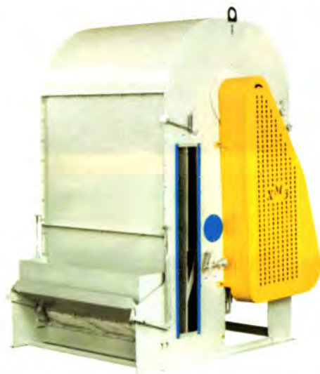
Фото 1. Сепаратор-аспіратор типу АСХ для видалення легких домішок при очищенні насіння
